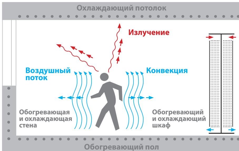
В гибких капиллярных трубках из высококачественного полипропилена, конструктивно объединенных в маты, циркулирует вода, которая немного холоднее или теплее воздуха в помещении (отопление:  $28-32^{\circ}\text{C}$ , охлаждение  $16-18^{\circ}\text{C}$ ).
